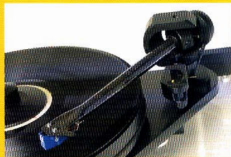
Le moteur est fixe et le plateau suspendu ; le bras est bien sûr signé Pro-Ject
